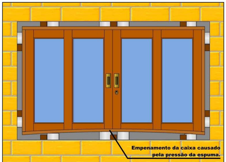
Figura 4 – Empenamento da esquadria causado pela pressão da espuma.
