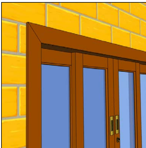
Figura 6 – Instalação das guarnições (alisares) com cortes em 45 graus.
