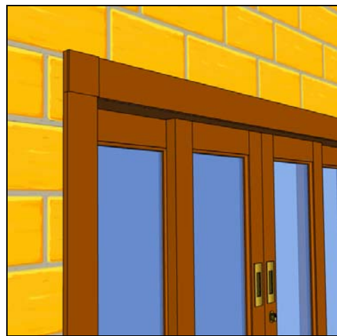
Figura 7 – Instalação das guarnições (alisares) com sóculos, cortes em 90 graus.
