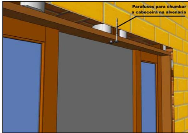
Figura 5 – Parafusos para chumbar a cabeceira na alvenaria.
